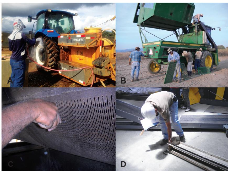
**Figura 16.** Limpieza de equipos y maquinaria utilizados en las labores de manipulación de los OVMs. A: Limpieza de las llantas de un tractor con agua a presión; B: Personal realizando la limpieza de una máquina cosechadora; C: Extracción minuciosa de semilla en una deslintadora de algodón; D: Encargado de la planta de procesamiento de semilla verificando la limpieza de cada parte del equipo utilizado para desmotar algodón, nótese que en su mano tiene un registro.
